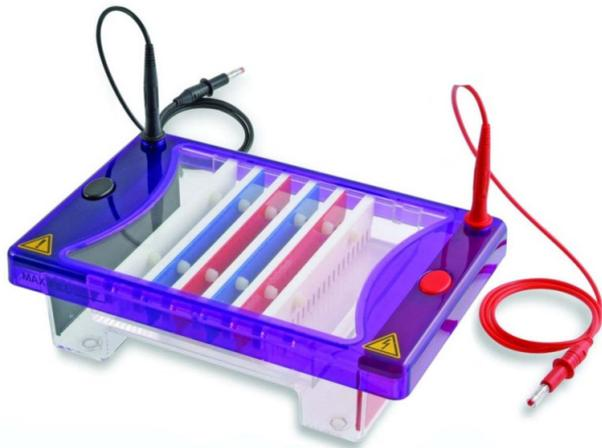
Camera per elettroforesi orizzontale modulare a tre vassoi 15×7/15×10/15×15 cm
