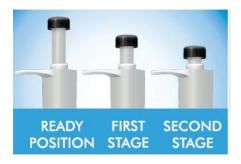
Sistema di dispensazione a doppio step, ciò determina un colpo d'ariete finale con conseguente erogazione fino all'ultima goccia di campione nel puntale; tale sistema determina un'elevatissima accuratezza e precisione.
